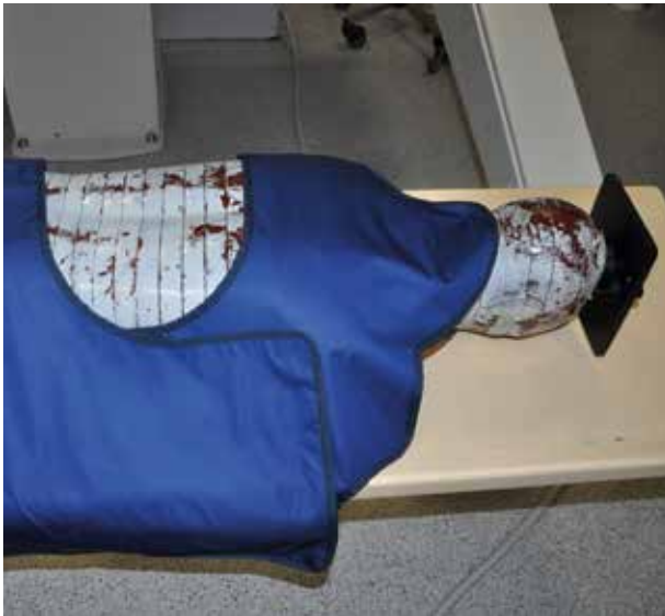
Abb. 2: Positionierung der Decke am Alderson-Rando-Phantom. Die beiden Teile der Decke werden vor Beginn der Untersuchung so justiert, dass der Ausschnitt dem größten zu erwartenden Bildausschnitt entspricht
